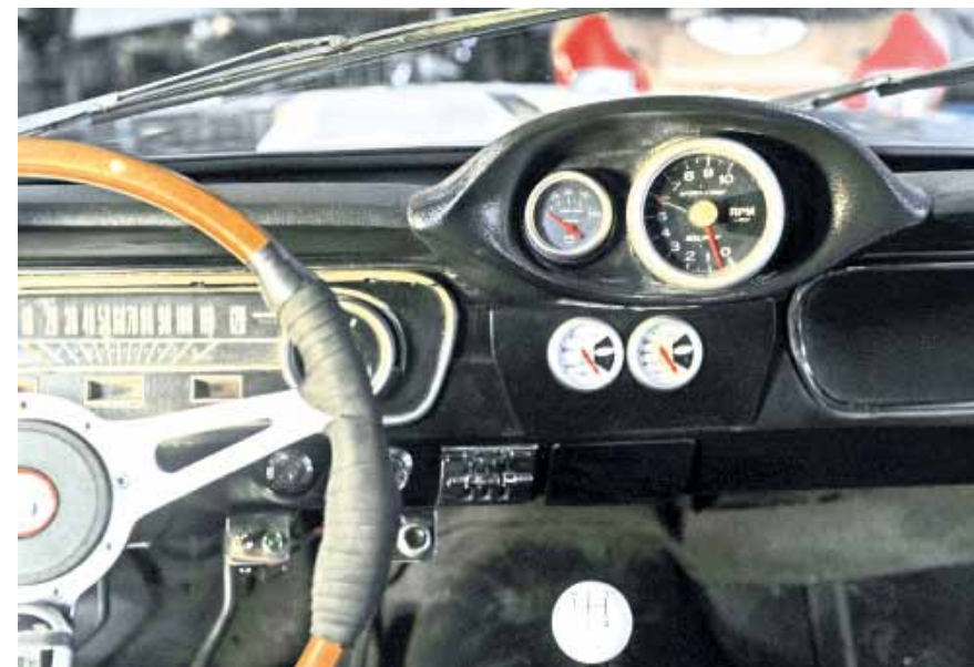
Poste de travail : le gros compte-tours est bien en vue, avec les manos essentiels pour surveiller la bonne marche de l'animal. Le volant bois est gainé de caoutchouc pour assurer la meilleure prise.
